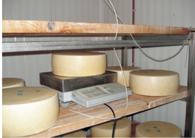
Πιλοτικός Θάλαμος (15 m 3 ) με αυτόματο σύστημα ζύγισης.
